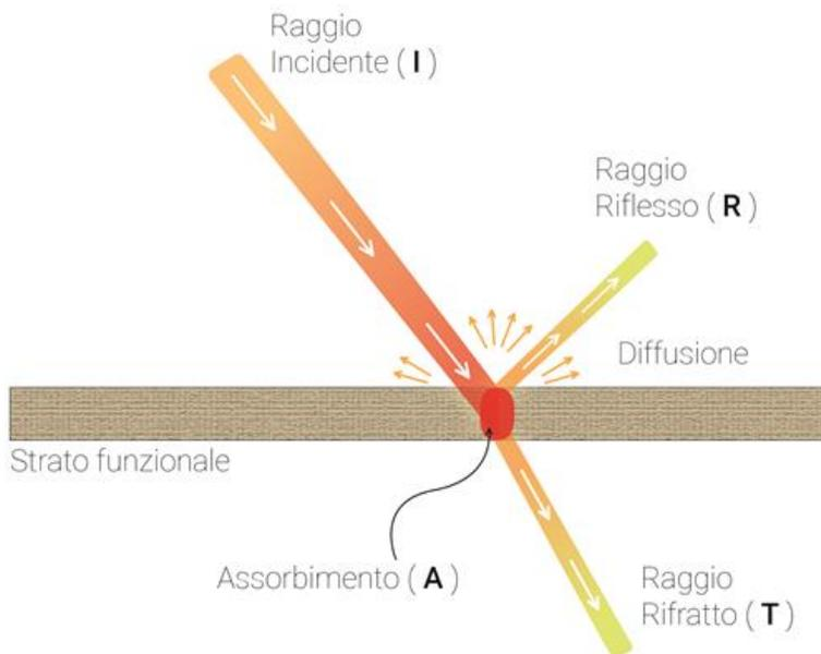
Figura 36. Schematizzazione dell'interazione tra raggio laser e bordo
