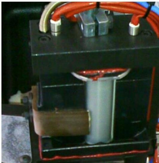
*Figura 62. Rullo applicatore correttamente alimentato*
