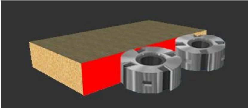
La rettifica è costituita da due motori verticali con frese specifiche per piccole asportazioni di materiale della superficie laterale del pannello. La lavorazione della rettifica serve a rendere la superficie del pannello perfettamente liscia, in preparazione della successiva fase di incollaggio. Le rettifiche generalmente sono di 2 tipi:
