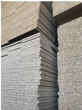
*Figura 5. Pannelli di particelle (truciolari)*
