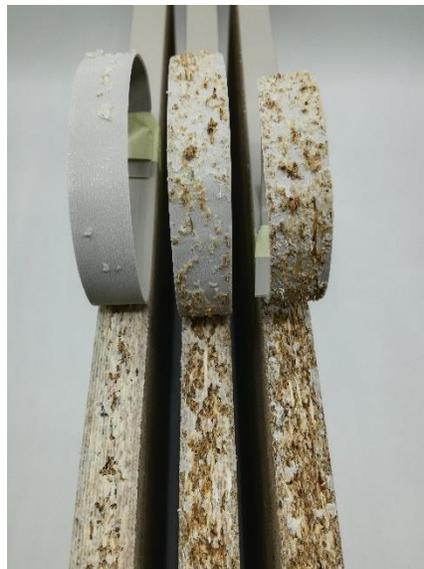
*Figura 38. Valutazione dell'incollaggio: non sufficiente (sinistra), sufficiente (centro), adeguato (destra)*
