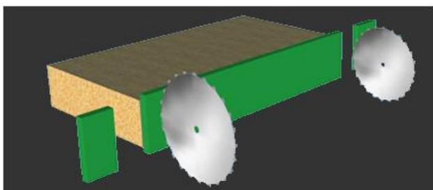
È un gruppo costituito da uno o due motori, con rispettive lame per il taglio dell'eccedenza di bordo anteriore e posteriore. Le lame sono in grado di tagliare sia i bordi in rotolo che i masselli di vario spessore.
