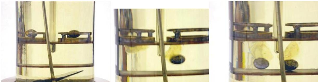
*Figura 10. Esecuzione della prova per la determinazione della temperatura di rammollimento*
