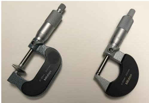
Lo strumento adatto alla misurazione dello spessore di bordi in carta, materiale plastico, alluminio o legno è il micrometro con superficie di lettura a cilindro e con precisione 0.01 mm. Oltre a quelli analogici (vedi foto) ne esistono anche altri con lettura in formato digitale.
