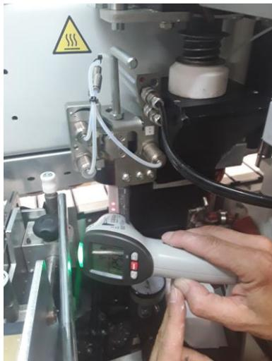
*Figura 60. Termometro a infrarossi sul rullo applicatore*
