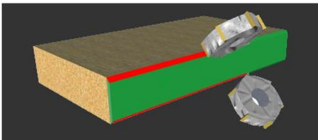
Questo gruppo, posto immediatamente dopo il rifilatore, effettua una lavorazione di finitura nel caso di bordi sottili (normalmente fino a 0,5 mm di spessore) mentre con bordi di spessore maggiore (normalmente da 0,6 mm a 3 mm) la lavorazione di finitura viene eseguita successivamente dal
