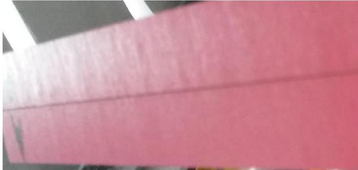
Per ridurre l'effetto buccia d'arancia, oltre a controllare l'affilatura degli utensili, bisogna controllare la pressione dei rulli pressori che non deve essere eccessiva e bisogna ridurre la velocità di avanzamento del pannello. Inoltre, può essere utile impiegare un utensile della rettifica con un maggior numero di taglienti.
