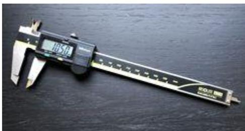
Lo strumento adatto alla misurazione della convessità di bordi in carta, materiale plastico, alluminio o legno è il calibro con risoluzione di 0.01 mm. Oltre a quelli analogici, ne esistono anche altri con lettura in formato digitale (vedi foto).
