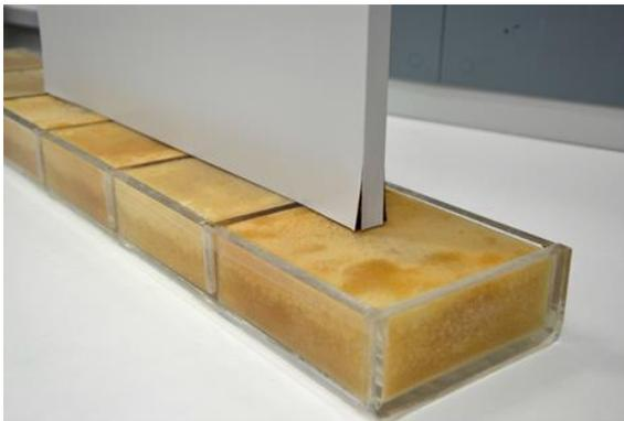
*Figura 46. Prova di resistenza dei bordi all'acqua*
