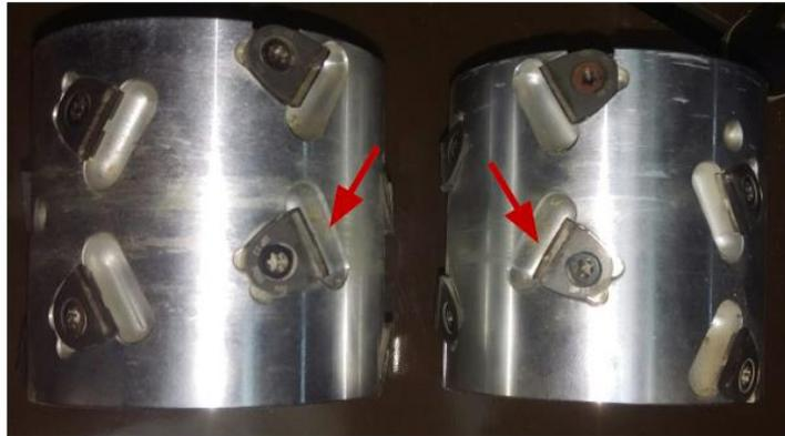
*Figura 72. Esempio di utensili della rettifica usurati*
