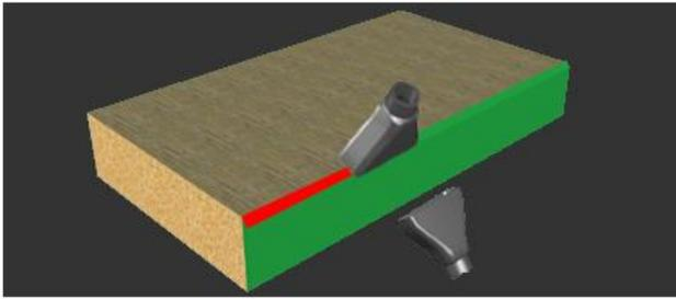
Il gruppo effettua una lavorazione di finitura nel caso di bordi in rotolo costituiti da materiale polimerico. È caratterizzato da due elementi riscaldanti, tipicamente ad aria calda, che tramite il calore ravvivano il colore del bordo e tendono ad annullare l'effetto di sbiancamento eventualmente causato dal raschiabordo.
