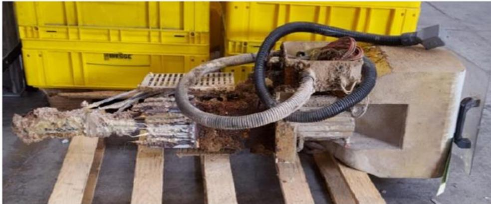
*Figura 49. Esempio di prefusore non pulito*
