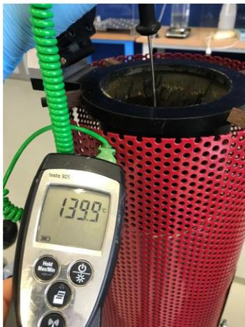
*Figura 50. Sonda ad immersione*
