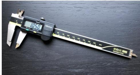
Lo strumento adatto alla misurazione della distorsione longitudinale di bordi in carta, materiale plastico, alluminio o legno è il calibro con precisione 0.01 mm. Oltre a quelli analogici ne esistono anche altri con lettura in formato digitale (vedi foto).
