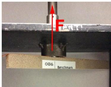
Figura 41. Prova di adesione – norma UNI 9240
