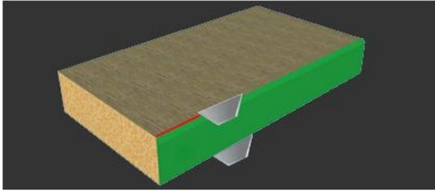
Il gruppo effettua una lavorazione di finitura nel caso di applicazione di bordi in rotolo. È costituito da due lamelle in grado di asportare l'adesivo in eccesso presente alle estremità superiore ed inferiore del bordo.
