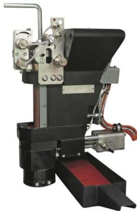
*Figura 34. Rullo spalmatore alimentato dall'alto*
