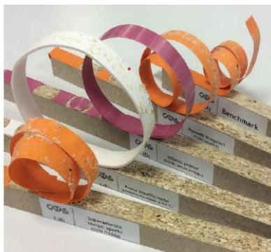
*Figura 44. Bordi dopo la prova di peeling a 90°*
