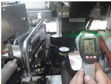
*Figura 53. Termometro ad infrarossi su testina dell'adesivo*
