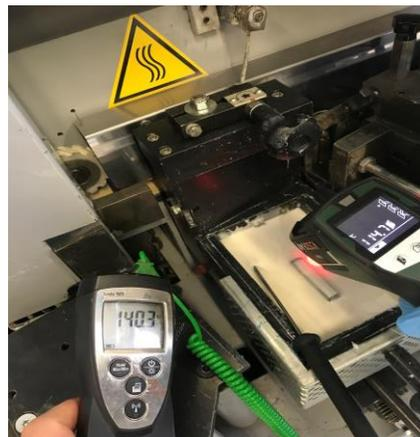
*Figura 58. Temperatura rilevata: differenza tra termometro a immersione e termometro a infrarossi*
