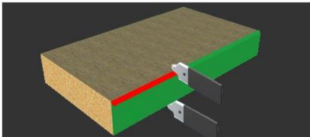
Il gruppo raschiabordo effettua una lavorazione di finitura, nel caso di bordi in rotolo. È costituito da due coltellini in grado di raschiare l'eccedenza di bordo superiore e inferiore lasciata in precedenza dallo spigolatore. Al termine della lavorazione, la superficie del bordo raschiato risulterà raggiata e perfettamente liscia e non si avrà più eccedenza di bordo rispetto al pannello.
