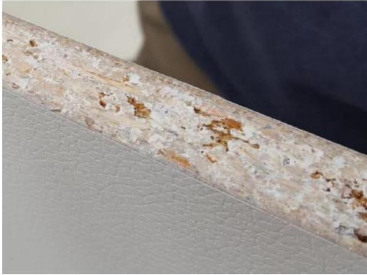
*Figura 71. Esempio di strato funzionale delaminato*
