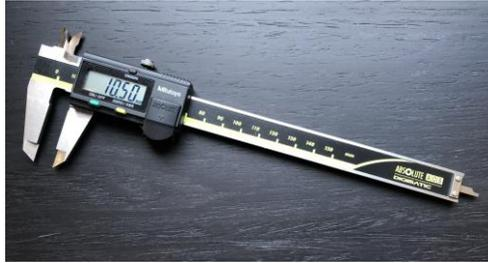
Lo strumento adatto alla misurazione dell'altezza di bordi in carta, materiale plastico, alluminio o legno è il calibro con precisione 0.01 mm. Oltre a quelli analogici ne esistono anche altri con lettura in formato digitale (vedi foto).
