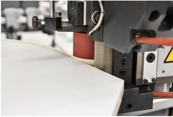
*Figura 20. Bordatura con Centro di Lavoro (CNC)*
