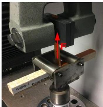
*Figura 43. Esecuzione della prova di peeling a 90°*
