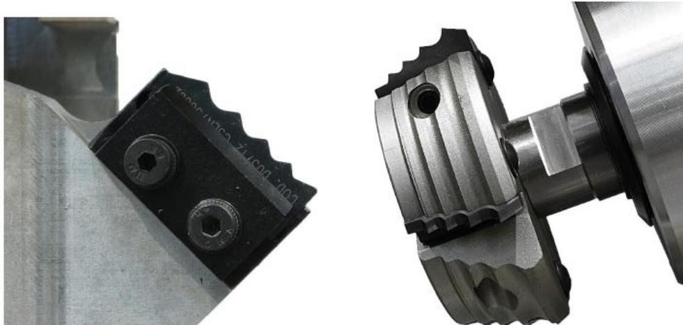
*Figure 79. Esempio di utensili correttamente affilati*
