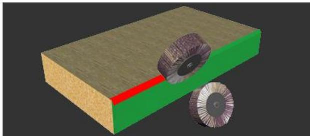
Il gruppo effettua una lavorazione di finitura, nel caso dell'applicazione di bordi in rotolo. È costituito da due motori dotati di apposite spazzole che, unite al liquido pulente, effettuano la pulizia e la lucidatura delle superfici lavorate dai precedenti gruppi funzionali.
