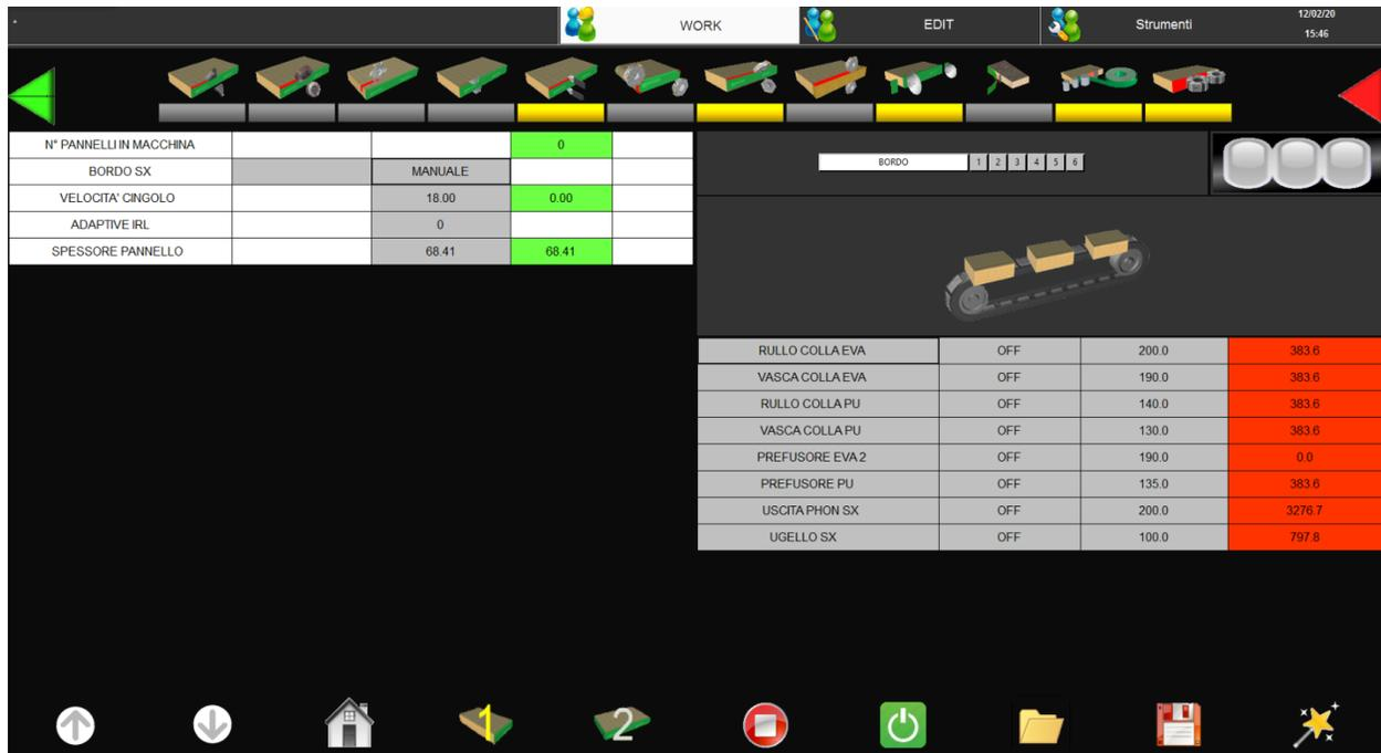
*Figura 52. Parametri di fusione sul controllo della bordatrice*
